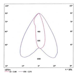
Classification des luminaires par UTE: 0.89B+0.01T CIE Flux Code: 72 92 98 99 90
