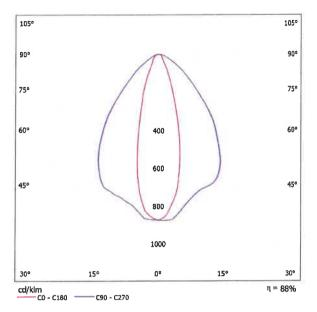
Classification des luminaires par UTE: 0.87C+0.01T CIE Flux Code: 69 91 98 99 88
